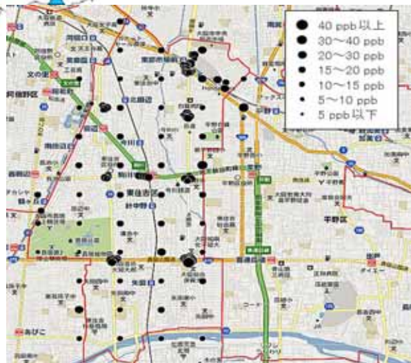
図5 道路沿道自動車排出ガス影響を調べた自主測定の例；東住吉区メッシュ測定と交差点などの自主測定結果とを合成表示
