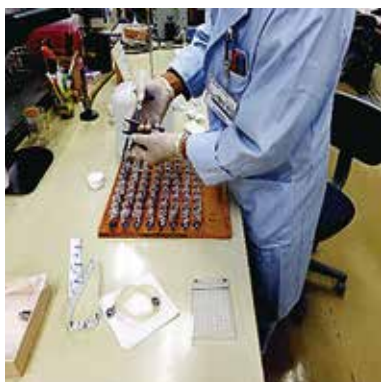
発色液 (ザルツマン試薬) を注入
