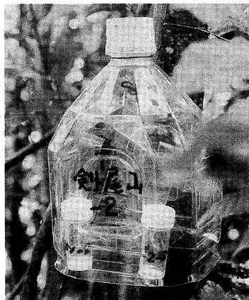
写真-3 山域地での測定（雨露を避けるためにペットボトルを使用）
