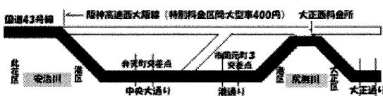
図1. 港区での国道43号線と高架道（立面図）
