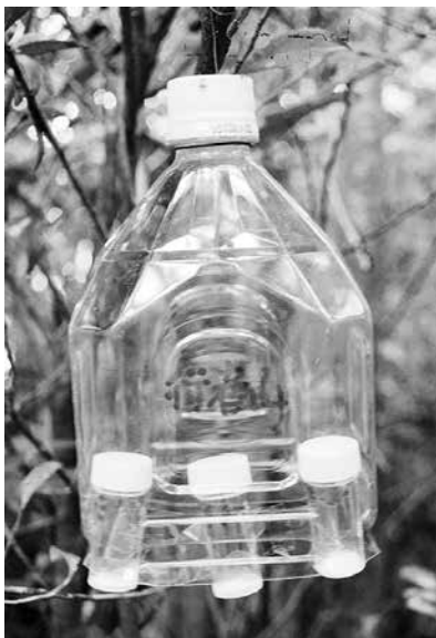
写真 山岳での測定用 （雨露を避けるためにペットボトルを使用）
