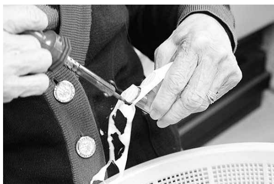
写真1 フィルター膜貼り付け作業
