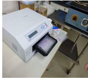
マイクロプレートを分光光度計で NO 2 濃度検出
